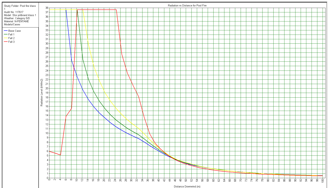
Figur B.5. Strålningsnivå i kW/m 2 på olika höjd över mark som funktion av avstånd. Brandscenario; pölbrand 200 m 2 , bensin, vind 5 m/s. Not: Avstånd (x-axel) räknas från centrum av pöl
